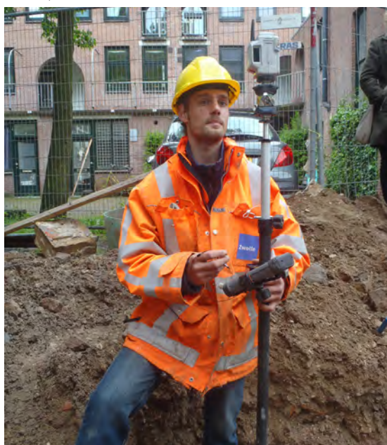
Afb.3.2. Met de GPS worden de diverse sporen ingemeten (Archeologie Zwolle, 2014).
