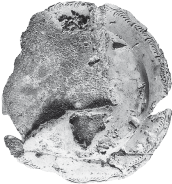
Afb. 13. Mal van plaster of Paris voor een 'feather-edge' bord, afkomstig uit het productieafval van William Greatbatch', Fenton, Stoke-on-Trent: 1770-1782 (collectie The Potteries Museum & Art Gallery).
