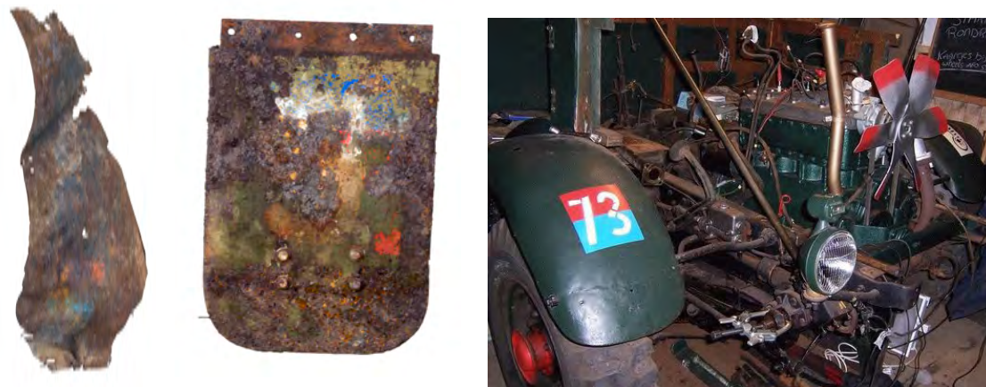
Figuur 127. Spatborden met zichtbare verfresten. Rechts een voorbeeld van een dergelijk aanduiding op het spatbord.
