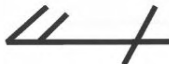
Afb. 10. timmermansmerk gebouw E
