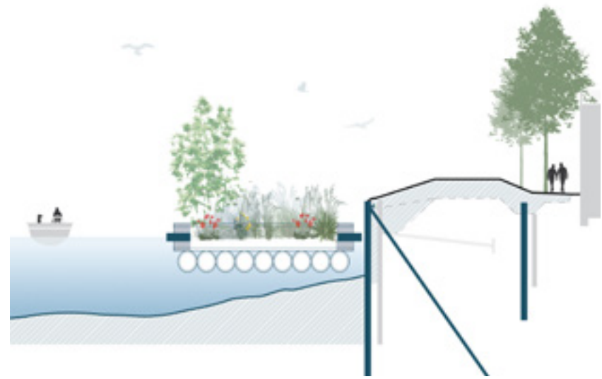
Versterking van de dijk langs het Zwanter Water: de stippellijn en grijze damwand geven de huidige situatie aan, terwijl de donkerblauwe damwand de toekomstige situatie laat zien.
