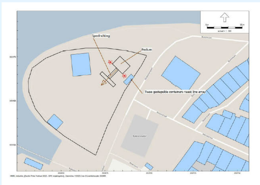
figuur 12: speelrichting podium 50 graden gedraaid in westelijke richting (bronmaatregel)
