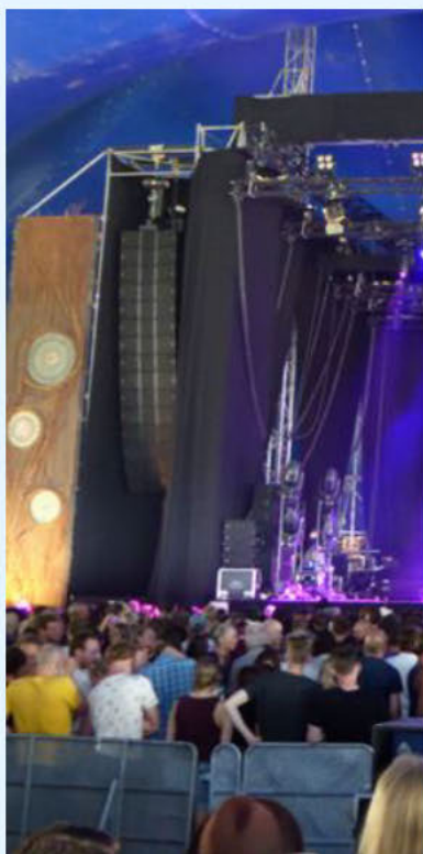
figuur 13: foto van afgeschermd line-array (overdrachtsmaatregel)
