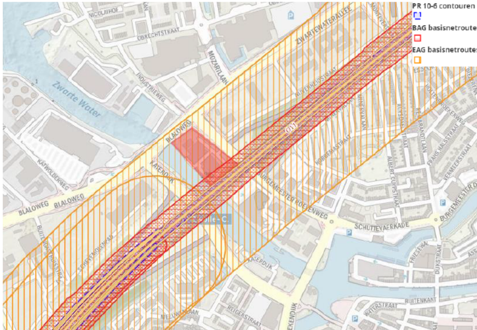
Figuur 3 PR10 6 per jaar contour, brand- en explosieaandachtsgebied A28 t.o.v. het plangebied (rode vlak)
